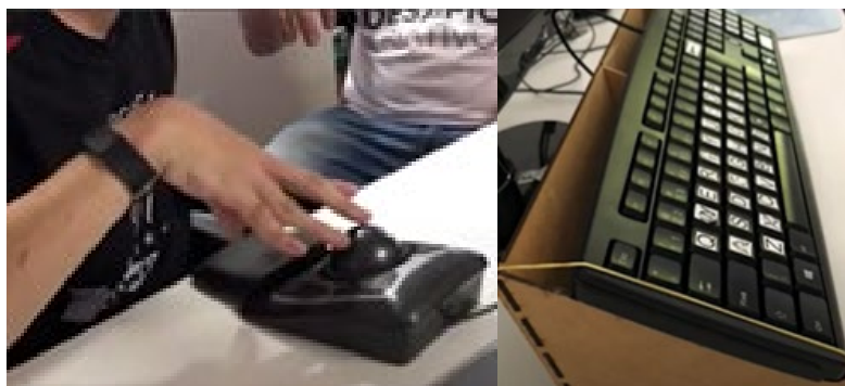
Figura 7 - Estudante testando mouse trackball e teclado com caracteres aumentados em relevo e suporte de MDF.
